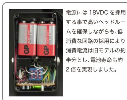
電源には 18VDC を採用する事で高いヘッドルームを確保しながらも、低消費な回路の採用により消費電流は旧モデルの約半分とし、電池寿命も約2倍を実現しました。
